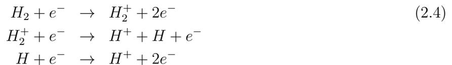
formant un plasma qui est accéléré et guidé par un champ électrique jusqu'à un orifice de sortie. A la sortie du duoplasmatron les protons ( $H^+$ ) ont une énergie de 100 keV et sont produits toutes les 100  $\mu s$ .
