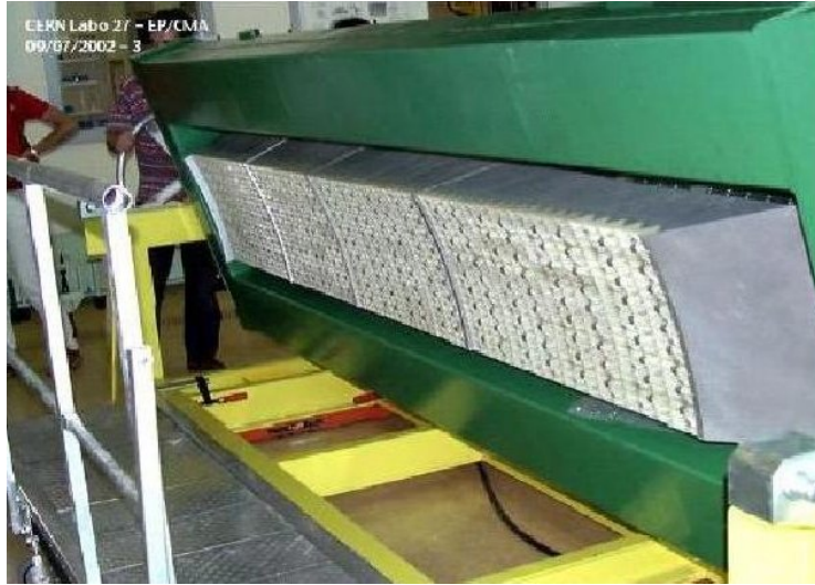
FIG. 2.4 – Photographie d'un supermodule du calorimètre ECAL montrant les modules qui le composent.
