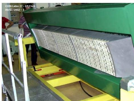
FIG. 4.2 – Supermodule du tonneau ([7], p. 147)
