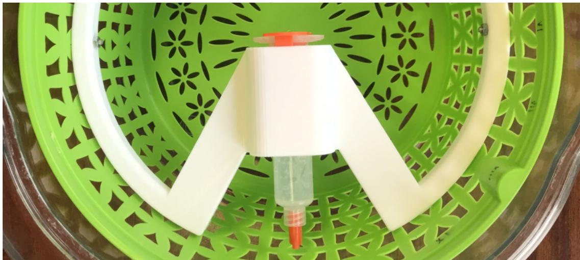
FIGURE 3.9 – Preuve de concept de la centrifugeuse. Une simple essoreuse à salade est utilisée pour centrifuger la seringue de colle.
