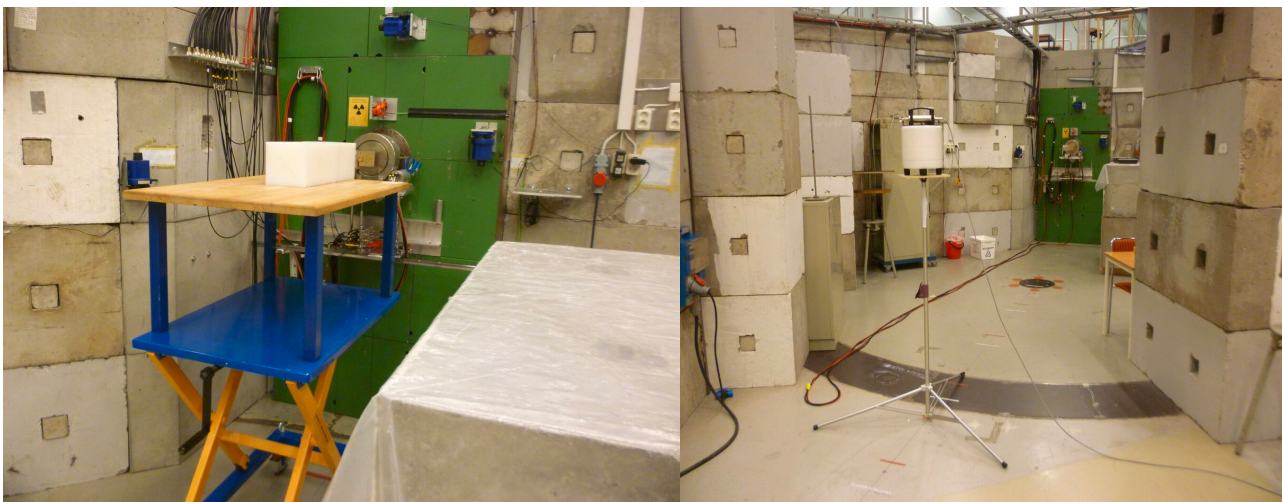
Figure V.10. Positionnement des plaques de polyéthylène (à gauche), l'irradiation du WENDI-2 sur l'ACF sans plaques de polyéthylène (à droite).
