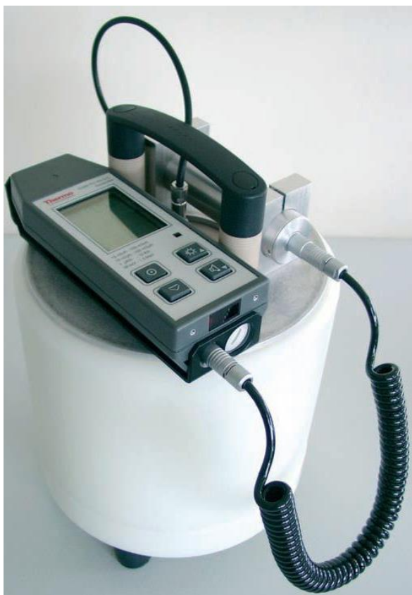
Figure IV.5. Une photo du compteur WENDI-2 connecté à un compteur FH40-G [166] et la coupe schématique du détecteur WENDI-2 [139].
