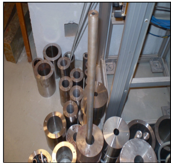
Figure V.3. L'ouverture du bloc de collimation du faisceau en fer à gauche, et à droite, différentes tailles de collimateurs qui peuvent être utilisés selon la taille du faisceau d'irradiation demandée [photo du TSL].
