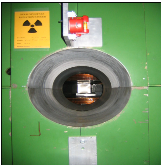
Figure V.3. L'ouverture du bloc de collimation du faisceau en fer à gauche, et à droite, différentes tailles de collimateurs qui peuvent être utilisés selon la taille du faisceau d'irradiation demandée [photo du TSL].
