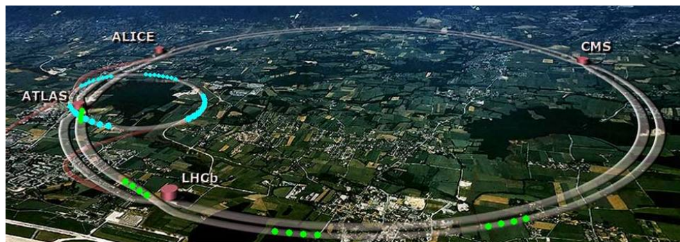
FIGURE 1.3 – Vue du ciel de la disposition des quatre principales expériences au LHC. ATLAS est situé en Suisse tandis que les autres détecteurs se trouvent en France. CMS est diamétralement opposé à ATLAS de manière à pouvoir optimiser simultanément le nombre de collisions de protons pour ces deux expériences. [15]
