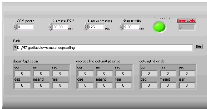
Figuur 3.7a: Voor het starten van het scanproces moeten de diameter van de FOV, de tijdsduur van de meting, de stapgrootte en het pad ingevuld worden. De Error-status en Error-code geven aan of en welke fout er opgetreden is. Ook wordt er voorspeld wanneer het scanproces afgelopen is.
